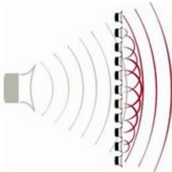
Abb. 14: Elementarwellen bilden eine Wellenfront
