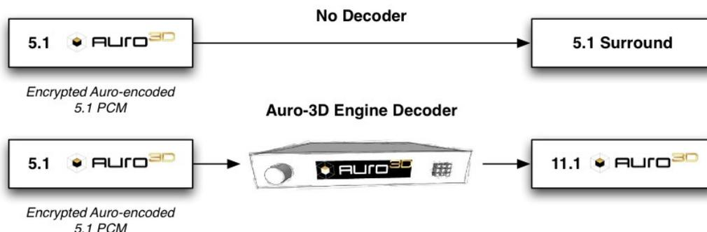
Abb. 21: Auro-codierter PCM Stream mit und ohne Decoding
