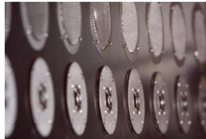
Abb. 15: Lautsprecherzeile (Line Array) eines Wellenfeldsynthese-Systems
